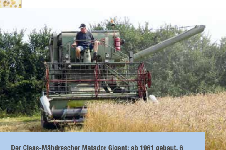
Der Claas-Mähdröschmaschine Matador Gigant: ab 1961 gebaut, 6 Zylinder, 87 PS, 5 Tonnen leicht. Im historischen Prospekt als „stärkster Claas-Mähdröschmaschine“ beworben, heute ein seltener Oldtimer. Sein Partner: ein Lanz-Bulldog-Traktor
